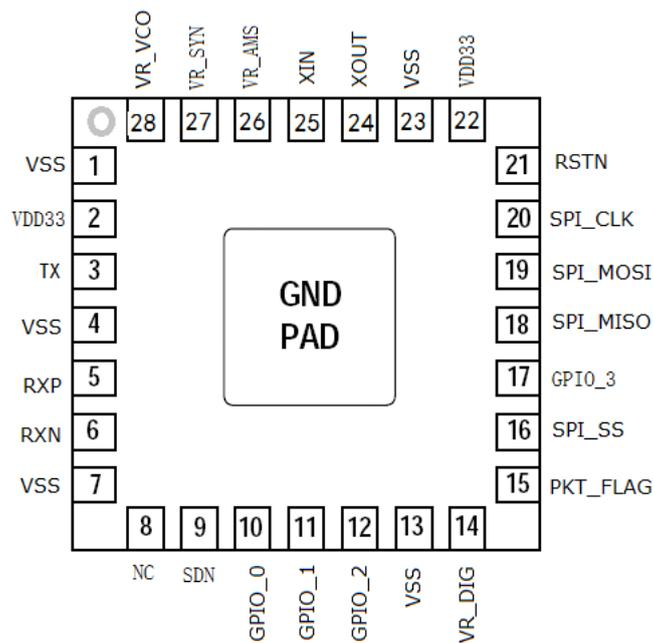
图5.1 QFN28引脚图
